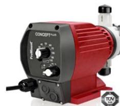
Все насосы стандартной комплектации (00A010) имеют гидравлическое подключение согласно техническим данным, электрическое подключение 100-230 V, 50/60 Hz с 2-х метровым Евро штекером (Euro Stecker), стандартный монтажный кабель. В комплект поставки входят приемный клапан, дозировочный вентиль, 2 м всасывающая трубка из PVC и 5 м напорная трубка из PE. Внешний контакт и Пауза
